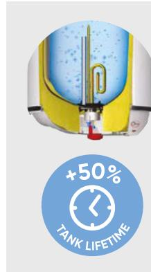
Jedinstveni O'Pro antikorozivni sustav izjednačava električni potencijal spremnika i uranajućeg grijajućeg elementa. Životni vijek magnezijeve anode tako je znatno proširen a time je i antikorozivna zaštita uređaja pojačana.
