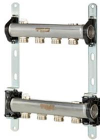
TTO Intera 52 – razdjelnik bez ventila sa spojevima s unutarnjim navojem od 1" na primarnoj strani, te 2-12 komada niklovanih eurokonus spojnica od 3/4" za spajanje krugova grijanja
