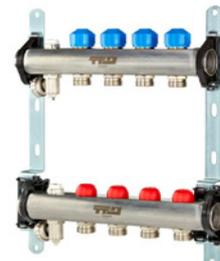
TTO Top 69 – razdjelnik s mehaničkim regulacijskim ventilima u polazu i termostatskim ventilima u povratu s unutarnjim navojem od 1" na primarnoj strani, te 2-12 komada niklovanih eurokonus spojnica od 3/4" za spajanje krugova grijanja
