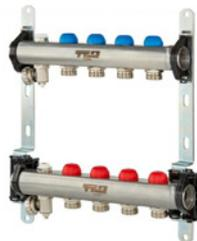
TTO Intera 55 – razdjelnik s mehaničkim regulacijskim ventilima u polazu i povratu s unutarnjim navojem od 1" na primarnoj strani, te 2-12 komada niklovanih eurokonus spojnica od 3/4" za spajanje krugova grijanja
