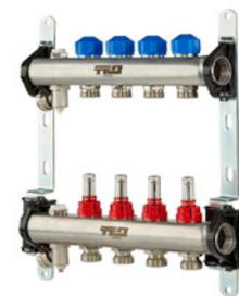
TTO Top 67 – razdjelnik s pokazivačima protoka u polazu i termostatskim ventilima u povratu s unutarnjim navojem od 1" na primarnoj strani, te 2-12 komada niklovanih eurokonus spojnica od 3/4" za spajanje krugova grijanja
