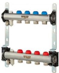
TTO Intera 55 – razdjelnik s mehaničkim regulacijskim ventilima u polazu i povratu s unutarnjim navojem od 1" na primarnoj strani, te 2-12 komada niklovanih eurokonusa spojnica od ¾" za spajanje krugova grijanja
