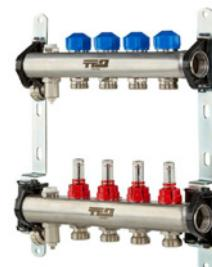
TTO Top 69 – razdjelnik s pokazivačima protoka u polazu i termostatskim ventilima u povratu s unutarnjim navojem od 1" na primarnoj strani, te 2-12 komada niklovanih eurokonusa spojnica od ¾" za spajanje krugova grijanja
