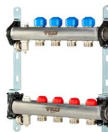
TTO Intera 59 – razdjelnik s mehaničkim regulacijskim ventilima u polazu i termostatskim ventilima u povratu s unutarnjim navojem od 1" na primarnoj strani, te 2-12 komada niklovanih eurokonusa spojnica od ¾" za spajanje krugova grijanja
