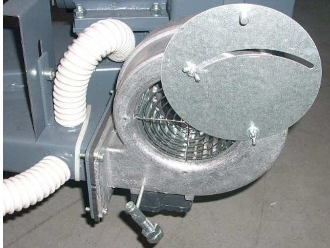
Slika 13. Položaj klapne ventilatora
