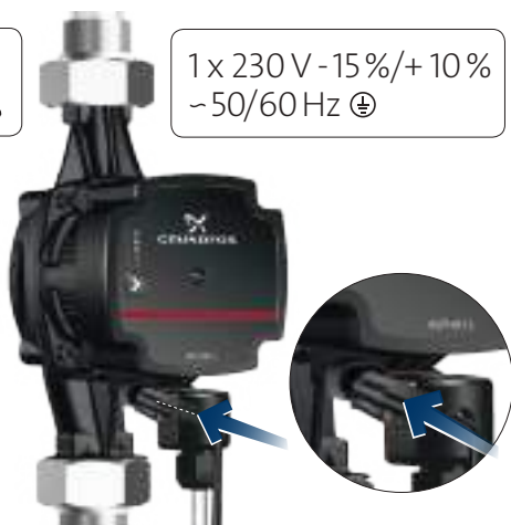
Spajanje signalnog kabela na ALPHA1 L
