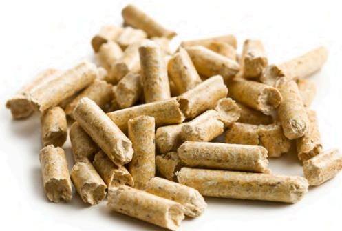
**Kotao je predviđen samo za sagorijevanje drvenog peleta promjera 6 mm i dužine od 10 do 30 mm.**
