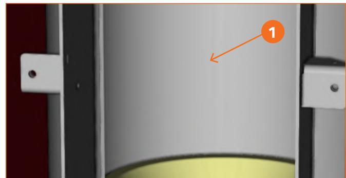
Po mogućnosti na vrh cijevi usisivača staviti tanki nastavak i detaljno očistiti otvore unutar ložišta te otvore primarnog i sekundarnog zraka
