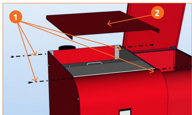
Izvaditi osjetnik temperature plamena iz ležišta (1) a zatim odviti četiri vijka M 8 koji priržavaju poklopac izmjenjivača topline.
