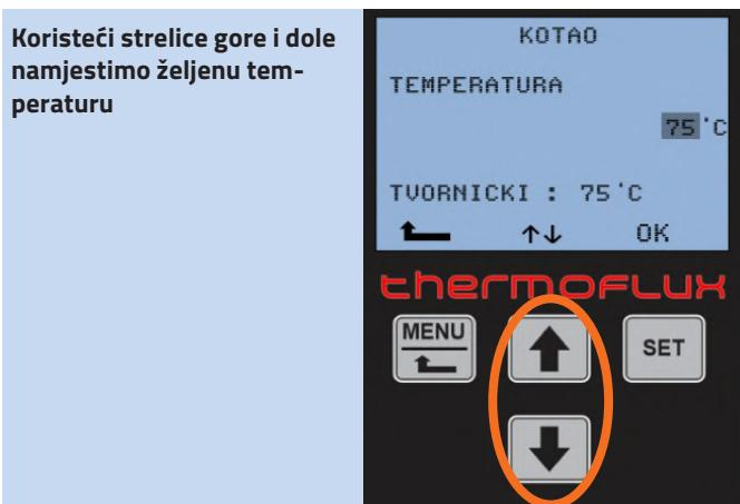
Odabranu temperaturu potvrdimo i sačuvamo pritiskom na OK (tipka SET), a zatim se vratimo natrag pritiskom na tipku MENU.
