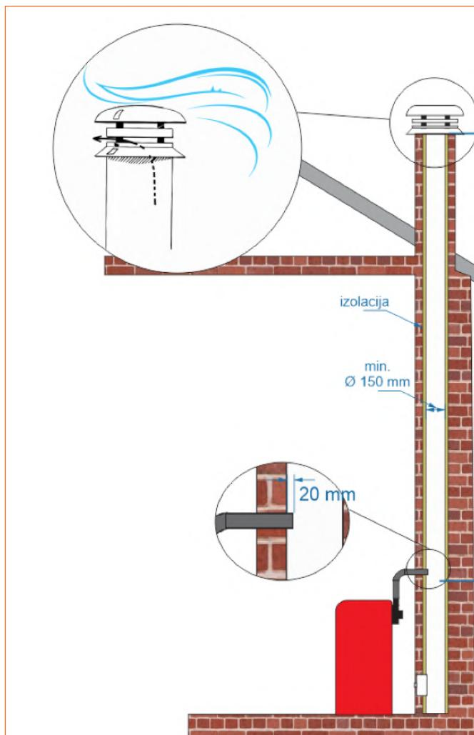
Unutrašnji presjek dimovodnih cijevi treba biti glatak i svi spojevi moraju biti hermetički spojeni. Treba izbjegavati što je više moguće montazu vodoravnih dijelova. Vodoravni dijelovi trebaju imati nagib od minimalno 3% prema gore. Dužina vodoravnog dijela treba biti minimalna i u svakom slučaju ne duža od 2 metra sa mogućnošću čišćenja i uklanjanja nakupljenog pepela. Priključak na dimnjak se treba izvesti sa maksimalno dva dimovodna koljena.
