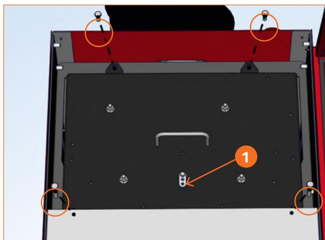
Zatim podići i skunuti poklopac izmjenjivača prema gore. Ostaviti ga sa strane pazeći da ne oštetimo cijev osjetnika temperature plamena.
