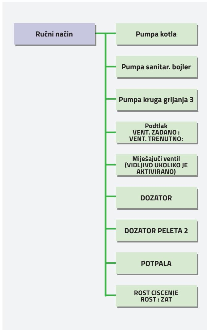
Izborom pojednine stavke iz izbornika možemo provjeriti njen rad. Aktiviranje komponente i provjera njenog rada se vrši tipkom SET. Izlaz iz izbornika se vrši tipkom MENU.
