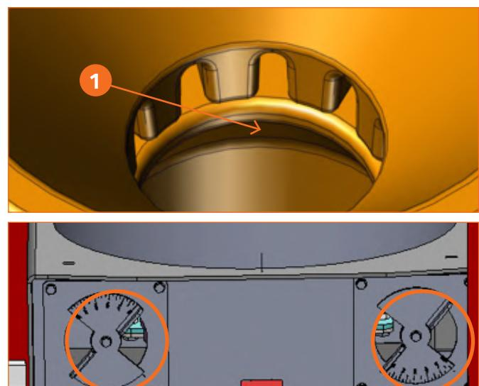
Skinuti dimovodne cijevi i odstraniti pepeo koji se nakupio u njima. Čišćenje dimovodnih cijevi je potrebno uraditi iz razloga što se pepeo često nakuplja u vodoravnim dijelovima.
