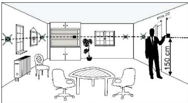
**EL** Ο θερμοστάτης πρέπει να τοποθετηθεί σε τέτοιο σημείο ώστε να μετράει τη θερμοκρασία του χώρου με τη μεγαλύτερη δυνατή ακρίβεια, χωρίς να είναι εκτεθειμένος άμεσα σε ηλιακή ακτινοβολία ή άλλες πηγές θέρμανσης ή ψύξης.
