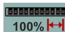
% otvorenosti rešetke (100%=otvorena) kada je rešetka na 100% mora biti prikazan crveni simbol
